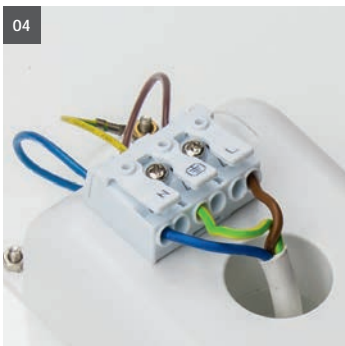
04. Netzkabel an Anschlussklemme anschließen. 04. Connect the power cable with the connecting terminal
