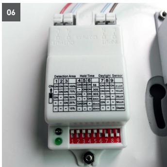
06. Einstellung an DIP switch vornehmen s.Schema 06. Adjust the DIP switch see scheme
