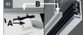
**03** Einsetzen und Verriegeln des 3-Phasen-Universaladapters Achtung! **Der Adapter lässt sich nur in eine Richtung richtig einsetzen!** Beim Einsetzen muss die Verriegelung (A) auf der Seite der Vertiefung (B) in der Stromschiene positioniert sein!
