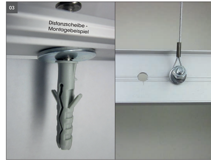
03 Die Leuchte an gewünschter Position mit den vorgesehenen Schraubenlöchern anzeichnen. Die Leuchte ist nicht zur Befestigung an unebenen Flächen geeignet. Die Leuchte mit den beigelegten Distanzscheiben zwischen der Rückseite der Montageplatte und der Wand / Decke befestigen. Ausreichend festen Sitz der Montageplatte kontrollieren. Das Oberteil der Leuchte wird durch das Sicherungsseil gehalten. Dieses darf nicht entfernt werden.
