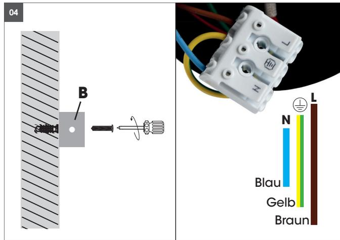
**04** Befestigen Sie den Montagebügel (**B**) mit geeigneten Montagematerial und kontrollieren Sie diesen danach auf festen Sitz.
