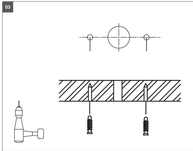
**03** Übertragen Sie die Bohrlöcher mit dem Montagebügel auf die Wand. **Achten Sie dabei auf darunterliegende Installationen vor dem Bohren.**
