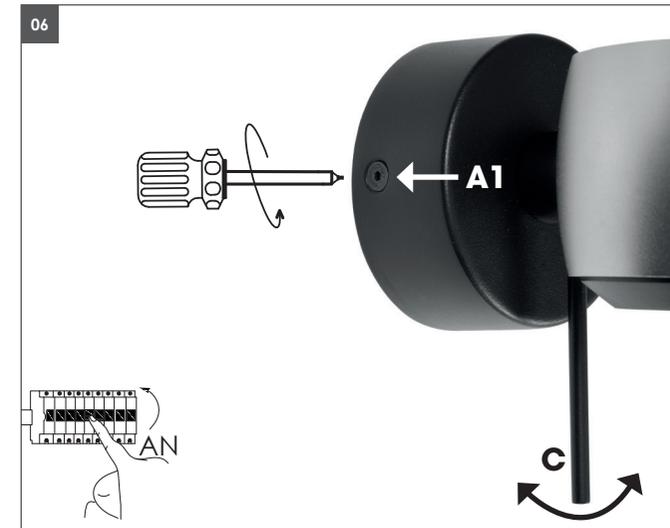
**06** Befestigen Sie den Wandbaldachin mit zwei Schrauben (**A1+A2**) an den Montagebügel. Schalten Sie nach der Montage und dem Anschluss die Netzspannung allpolig an. **Vorsicht der Leuchtenkörper ist nach langem Betrieb sehr warm.**
