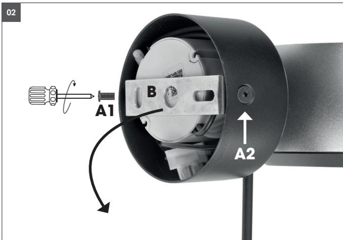
**02** Lösen Sie die 2 seitlichen Schrauben (**A1+A2**) am Wandbaldachin und entnehmen Sie den Montagebügel (**B**).
