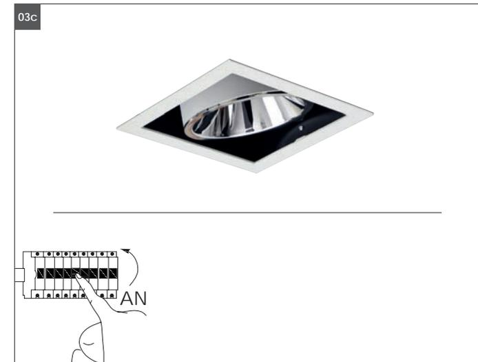
Schalten Sie nach der Montage und dem Anschluss die Netzspannung allpolig an. Schalten Sie dazu den zugehörigen Sicherungsautomaten an bzw. drehen Sie die Sicherung ein. Schalten Sie außerdem den zugehörigen FI-Schutzschalter an, so dass die Netzleitung allpolig mit der Netzspannung verbunden ist.
