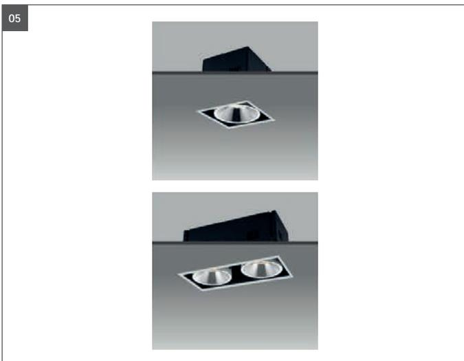
**05** Die Leuchte zusammen mit dem LED Konverter in die vorbereitete Öffnung einschieben bis der Rand bündig an der Decke anliegt. Es ist auf genügend Abstand zwischen der LED Leuchte und den dahinter verbauten Anlagen, Decken, Heizungsrohre, etc. zu achten. Um Stauwärme zu vermeiden ist die nötige Einbautiefe einzuhalten (allseitig zusätzlich 30 mm Abstand, siehe technische Daten).
