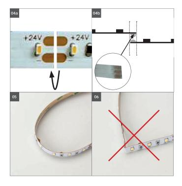
**04a.** Verbindung von Teilmodulen durch Auflöten einer Brücke. An den Lötpunkten oben (**Bild 04b**) und unten miteinander verlöten. Lötpunkte unten werden erst sichtbar wenn man die Schutzfolie abzieht. Bitte Schutzfolie nicht komplett abziehen, damit das FLEXY-Band nicht die Klebekraft verliert!
