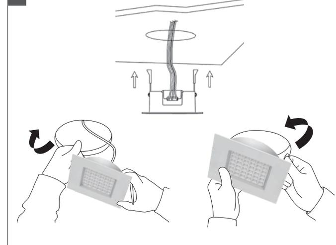
Seitlich angeordneten Spannklemmern nach oben drücken und Leuchte in den Deckenausschnitt einsetzen, auf festen bündigen Sitz achten.
