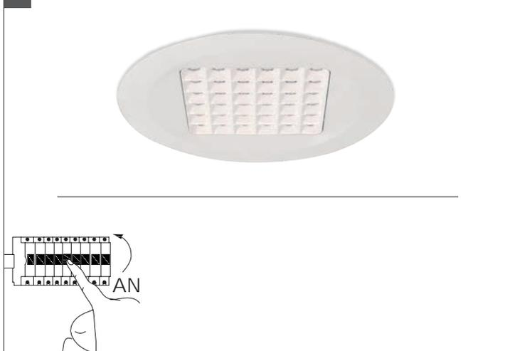
Schalten Sie nach der Montage und dem Anschluss die Netzspannung allpolig an. Schalten Sie dazu den zugehörigen Sicherungsautomaten an bzw. drehen Sie die Sicherung ein. Schalten Sie außerdem den zugehörigen FI-Schutzschalter an, so dass die Netzzuleitung allpolig mit der Netzspannung verbunden ist.
