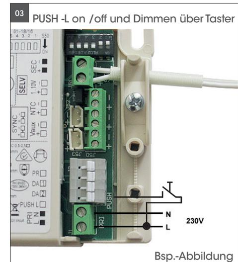
03. Verbinden Sie die Anschlusskabel am Netzteil, siehe Abb. 03. Anschließend schließen Sie das Netzteil an der Leuchte an und verbinden das Netzteil mit dem Stromnetz max., Leiterquerschnitt 1,5mm<sup>2</sup>. Für den PUSH -L Dimm Eingang immer nur die Phase verwenden, die auch das Netzteil versorgt! Die DIP-Einstellung ist leuchtenbezogen eingestellt und darf nicht verändert werden!
