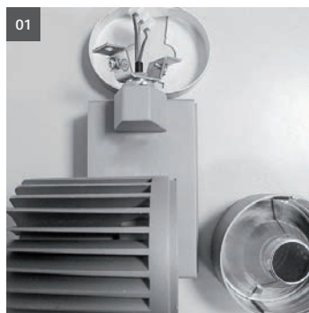
01. Deckenrosette u. Reflektorgehäuse demontieren und Kühlkörper 90° zum Vorschaltgerätgehäuse drehen. 01. disassemble ceiling rosette and reflector body, turn heat sink 90° to body of electronic ballast
