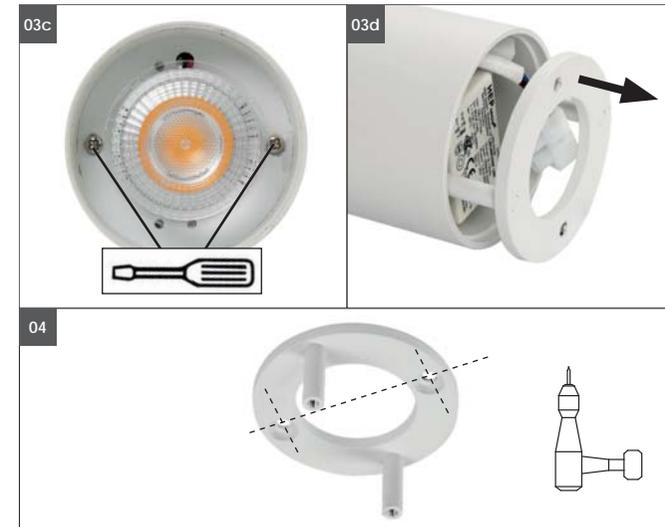
**03c** 2x Kreuzschrauben vollständig lösen.
