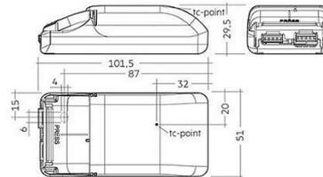
Vorschaltgerät für LEDs, 20W, 350-700mA, mit Zugentlastung
